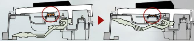
Die **Tri-Sensor Hammermechanik II** reagiert mittels eines integrierten Systems mit drei Sensoren, das sequentiell erkennt, wenn eine Taste angeschlagen wird. Dies erlaubt feinste spezifische Variationen in der Zeit zwischen dem Tastenanschlag und der Klangerzeugung, abhängig von der Anschlagsgeschwindigkeit. Wie bei einem echten Flügel ist die Hammermechanik vom Gewicht der
