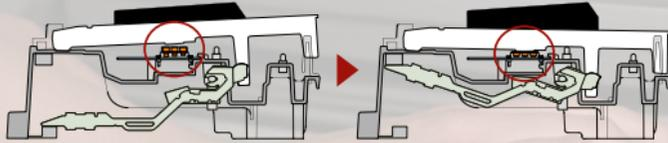
Die **Tri-Sensor Hammermechanik II** reagiert mittels eines integrierten Systems mit drei Sensoren, das sequentiell erkennt, wenn eine Taste angeschlagen wird. Dies erlaubt feinste spezifische Variationen in der Zeit zwischen dem Tastenanschlag und der Klangerzeugung, abhängig von der Anschlagsgeschwindigkeit. Wie bei einem echten Flügel ist die Hammermechanik vom Gewicht der Hämmer
